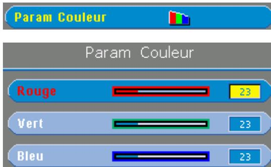
Ce mode vous permet de régler manuellement les paramètres des couleurs rouge, vert, et bleu. Le fait de modifier ces valeurs changera automatiquement la température à "utilisateur".
